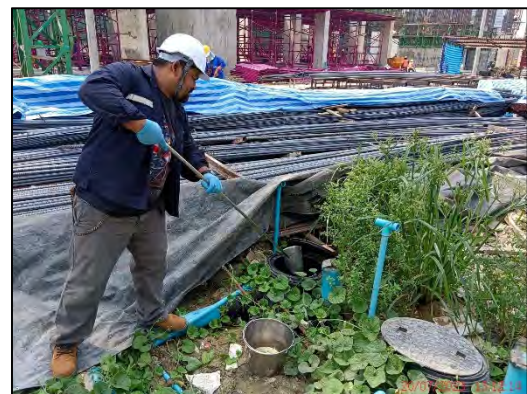
บริเวณระบบบำบัดน้ำเสียหลังผ่านการบำบัด การเก็บตัวอย่างน้ำเสีย
